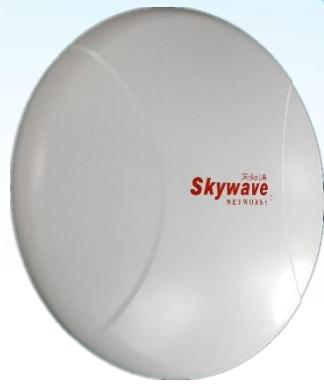
**Skywave** (天际通) SW8000-BI300 是一款室外工业级扇区天线一体化无线基站，工作在 5GHz 免许可频段，是一款符合 IEEE802.11a/n 标准的无线网络设备。产品采用高性能的高通 Atheros 高速网络处理器，基于 IEEE802.11a/n 的 MIMO (多进多出) 技术，采用 2T2R 构架，支持无线传输速率高达 300Mbps，射频合并功率输出最高可达 2\*500mW，灵敏度高达-98dBm，设备集成 2\*2 板状扇区天线，特别适用于长距离骨干网传输工程及大数据流实时业务如工地、电梯、小区、油田、电力、水利、林业、工矿企业、平安城市、智能交通、数字化能源等高清视频监控应用。
