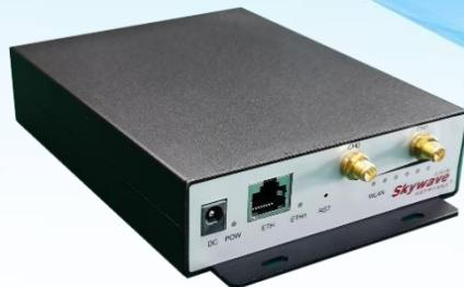
**Skywave** (天际通) SW8000-CT5330 是一款工业级无线漫游终端，工作在 5GHz 免许可频段，是一款符合 IEEE802.11n 标准的无线网络设备，专为移动无线宽带网络通信而设计。产品基于 IEEE802.11n 的 MIMO (多进多出) 技术，采用 2T2R 构架，支持无线传输速率高达 300Mbps，同时向下兼容 802.11a 标准。支持在不同基站间的高速无缝漫游，先进的漫游算法和专门设计的自定义信号阈值功能，从而保证网络的正常通信和数据的传输。射频功率输出单通道最高可达 2\*500mW，灵敏度高达-98dBm，设备集成 2\*SMA-K 天线接口，可以根据现场的情况外接不同型号的天线，特别适用于物流仓储、智能制造、港口码头、轨道交通、电厂电网、金属冶炼、智慧矿山、综合管廊、驾培驾校、机械作业自动化、智能安保、AGV 机器人等各行业移动宽带通信的应用。
