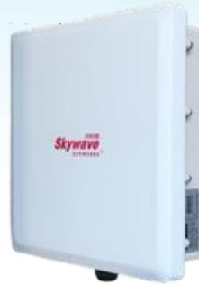
**Skywave** (天际通) SW8000-BV800 是一款室外电信级天线一体化无线基站，工作在 5GHz 免许可频段，是一款符合 IEEE802.11ac 标准的无线网络设备。产品采用高性能的高通 Atheros 高速网络处理器，基于 IEEE802.11ac 的 MIMO (多进多出) 技术，采用 2T2R 构架，支持无线传输速率高达 867Mbps。同时向下兼容 802.11a/n 标准，射频合并功率输出最高可达 2\*500mW，灵敏度高达 -98dBm，设备集成 2\*2MIMO 板状定向天线，特别适用于长距离骨干网传输工程及大数据流实时业务如油田、电力、水利、林业、工矿企业、平安城市、智能交通、数字化能源等高清视频监控应用。
