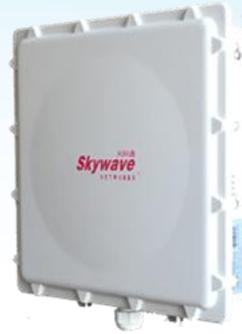
**Skywave** (天际通) SW8000-BS6800 是一款室外电信级无线漫游基站, 工作在 5GHz 免许可频段, 是一款符合 IEEE802.11a/n/ac 标准的无线网络设备, 专为移动无线宽带网络通信而设计。产品基于 IEEE802.11n/ac 的 MIMO (多进多出) 技术, 采用 2T2R 构架, 支持无线传输速率高达 867Mbps, 同时向下兼容 802.11a 标准, 射频功率合并输出最高可达 2\*500mW, 灵敏度高达 -98dBm。支持在不同基站间的高速无缝漫游, 先进的漫游算法和专门设计的自定义信号阈值功能, 配合专用无线控制器和无线车载终端, 从而保证数据和视频的正常传输, 真正做到无缝漫游、切换不丢包、数据上传不丢失、视频流畅。设备采用 2\*N 型射频接口, 可以根据现场的情况外接不同型号的天线, 特别适用于物流仓储、智能制造、港口码头、轨道交通、电厂电网、金属冶炼、智慧矿山、综合管廊、驾培驾考、机械作业自动化、智能安保、AGV 机器人等各行业移动宽带通信的应用。
