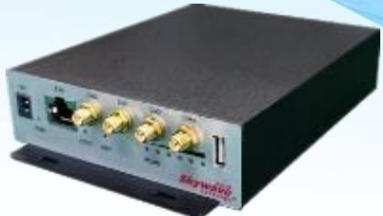
**Skywave** (天际通) SW8000-BI6300D 是一款工业级无线漫游基站，内置双路 5GHz 射频，是一款符合 IEEE802.11n 标准的无线网络设备，专为移动无线宽带网络通信而设计。产品基于 IEEE802.11n 的 MIMO (多进多出) 技术，采用 4T4R 构架，支持无线传输速率高达 2\*300Mbps，同时向下兼容 802.11a 标准，射频功率合并输出最高可达 4\*500mW，灵敏度高达 -98dBm。支持在不同基站间的高速无缝漫游，先进的漫游算法和专门设计的自定义信号阀值功能，配合专用无线控制器和无线车载终端，从而保证数据和视频的正常传输，真正做到无缝漫游、切换不丢包、数据上传不丢失、视频流畅。设备采用 4\*SMA-K 天线接口，可以根据现场的情况外接不同型号的天线，特别适用于物流仓储、智能制造、港口码头、轨道交通、电厂电网、金属冶炼、智慧矿山、综合管廊、驾培驾校、机械作业自动化、智能安保、AGV 机器人等各行业移动宽带通信的应用。
