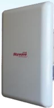
**Skywave** (天际通) SW8000-BSU6300D 是一款室外电信级无线漫游基站，工作在 5GHz 免许可频段，是一款符合 IEEE802.11n 标准的无线网络设备，专为移动无线宽带网络通信而设计。产品基于 IEEE802.11n 的 MIMO (多进多出) 技术，采用 4T4R 构架，支持无线传输速率高达 2\*300Mbps，同时向下兼容 802.11a 标准，射频功率合并输出最高可达 4\*500mW，灵敏度高达 -98dBm。支持在不同基站间的高速无缝漫游，先进的漫游算法和专门设计的自定义信号阀值功能，配合专用无线控制器和无线车载终端，从而保证数据和视频的正常传输，真正做到无缝漫游、切换不丢包、数据上传不丢失、视频流畅。设备集成 90 度双极化扇区天线，或扩展出 2\*N 型射频接口，可以根据现场的情况外接不同型号的天线，特别适用于物流仓储、智能制造、港口码头、轨道交通、电厂电网、金属冶炼、智慧矿山、综合管廊、驾培驾考、机械作业自动化、智能安保、AGV 机器人等各行业移动宽带通信的应用。
