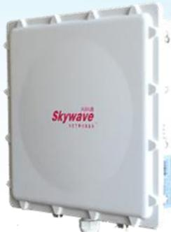
**Skywave** (天际通) SW8000-CT6326 是一款工业级无线漫游终端，工作在 5GHz 免许可频段，是一款符合 IEEE 802.11a/n 标准的无线网络设备，专为移动无线宽带网络通信而设计。产品基于 IEEE802.11n 的 MIMO (多进多出) 技术，采用 2T2R 构架，支持无线传输速率高达 300Mbps。支持在不同基站间的高速无缝漫游，先进的漫游算法和专门设计的自定义信号阈值功能，从而保证网络的正常通信和数据的传输。射频合并功率输出最高可达 2\*200mW，灵敏度高达-98dBm，设备采用 2\*N 型天线接口，可以根据现场的情况外接不同型号的天线，特别适用于物流仓储、智能制造、港口码头、轨道交通、电厂电网、金属冶炼、智慧矿山、综合管廊、驾培驾考、机械作业自动化、智能安保、AGV 机器人等各行业移动宽带通信的应用。
