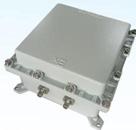
**Skywave** (天际通) SW8000EXD-S800 是一款防爆型室外电信级分体无线网桥，工作在5GHz 免许可频段，符合 IEEE802.11ac 标准的无线网络设备。产品采用高性能的高通Atheros 高速网络处理器，基于 IEEE802.11ac 的 MIMO (多进多出) 技术，采用 2T2R 构架，支持无线传输速率高达 867Mbps，同时向下兼容 802.11a /n 标准，射频合并功率输出最高可达 2\*500mW，灵敏度高达-98dBm，设备采用 2\*N 型射频接口，可以根据现场的情况外接不同型号的天线，特别适合化工、制药、石油化工及能源等行业的危险品生产、物流、仓储等环节，以及石油天然气开采平台、天然气储存场地、地下管廊等应用场合。
