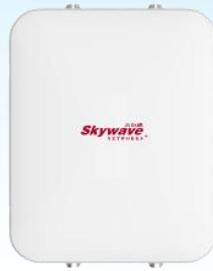
**Skywave** (天际通) SW8000-WAP5400AXE是一款支持802.11a/b/g/n/ac/ax技术的新一代高性能室外AP产品,工作在2.4GHz/5.8GHz免许可频段,采用MU-MIMO、OFDMA、TWT、WAPI等先进技术,符合中国无线局域网国家标准GB 15629.11系列,支持WAPI安全功能,支持2.4GHz和5GHz三频并发,最高可提供5375Mbps的数据传输速率。AP采用铸铝金属外壳,IP68封装,工作在FAP/TAP模式下,支持AC控制器统一管理,具有AP零配置、无缝漫游、传输速率高、稳定性好,接收灵敏度高、传输距离远等特点,特别适用于电厂电网、轨道交通、公安武警、国防军队、海关边防等对安全性敏感行业无线宽带通信应用。
